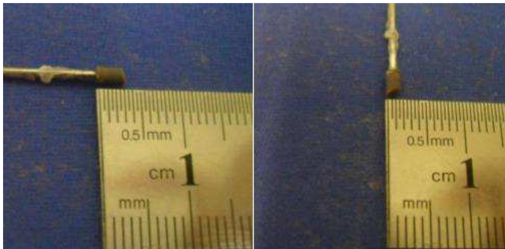
Figura 22: Extração da subamostra utilizada para a microtomografia.
