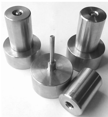
Figura 11 - Molde em inox utilizado para confecção dos corpos de prova para as caracterizações eletromagnéticas.
