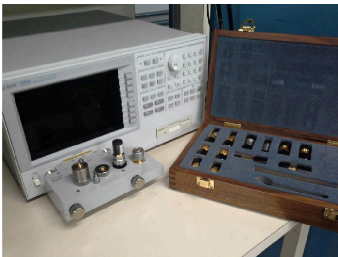
Figura 12 - Analisador de Impedância Agilent modelo 4294A com adaptador (Zanella, 2013).
