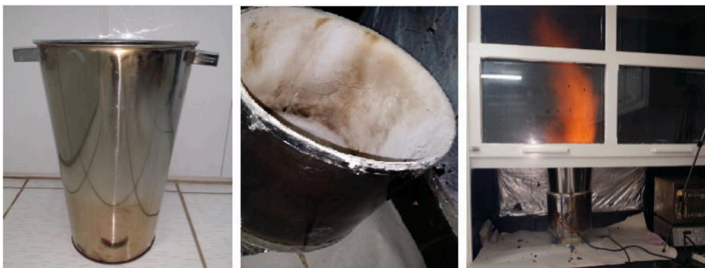
Figura 10- Recipiente e reator utilizado para a obtenção de ferritas Mn-Zn por reação de combustão.
