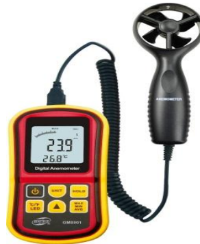
Figura 3.26. Anemômetro usado para medir a velocidade do ar.
