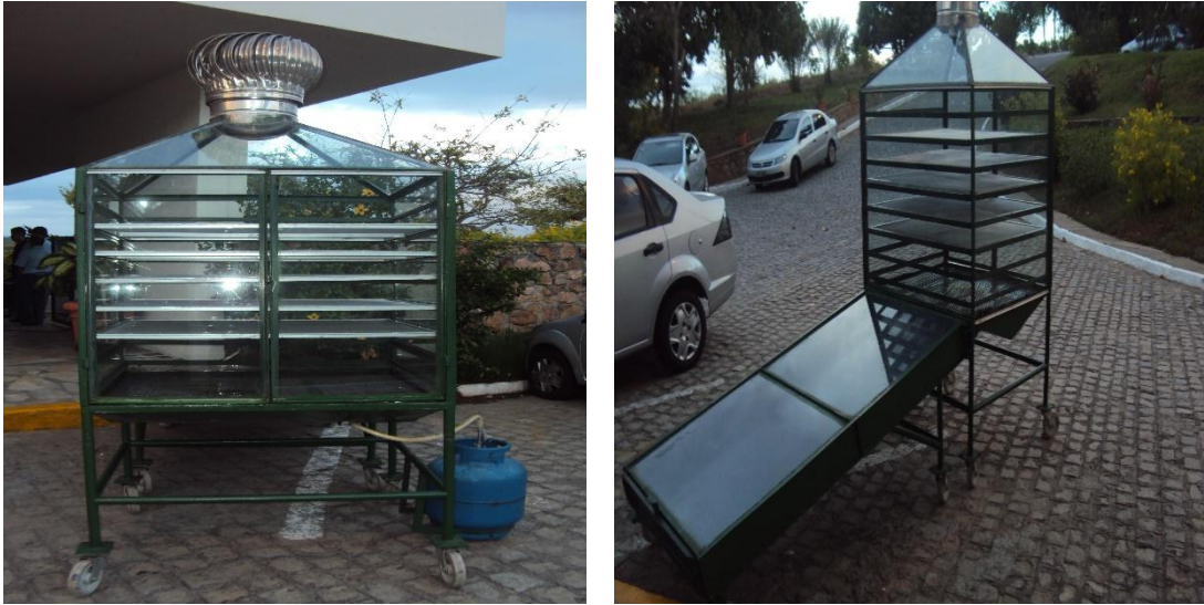
Figura 2.4. Secador solar construído na Universidade Federal de Sergipe, UFS.
