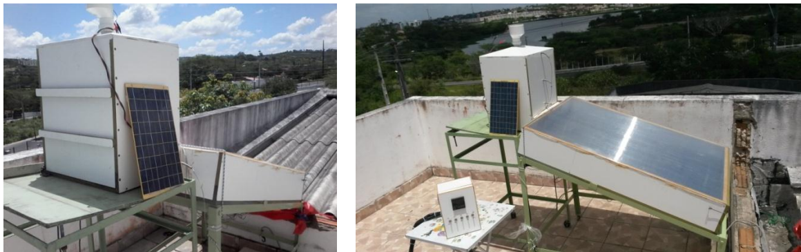
Figura 3.10. Câmara de secagem em funcionamento no solarium .
