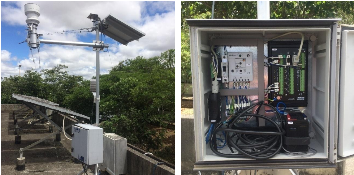
Figura 3.23. Estação meteorológica modelo HD32MT.1, SN 11031486 e FW 0714141114.
