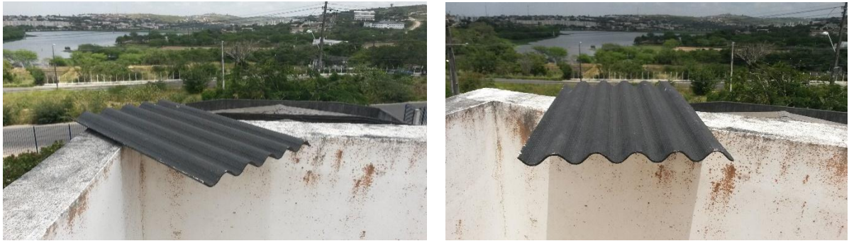
Figura 3.6. Telha de fibrocimento pintada de preto fosco utilizada como capacitor térmico.
