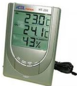
Figura 3.18. Termo-Higrômetro usado para medir a umidade relativa do ar nos experimentos de 1 a 4.
