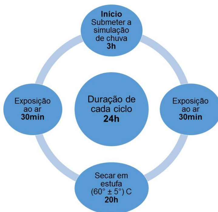
Figura 6 - Ciclo de molhagem e secagem através do ensaio da chuva dirigida.
