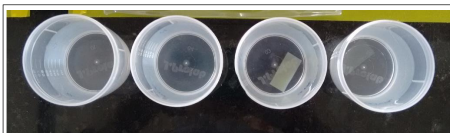
Figura 22 - Amostras durante o ensaio de Biodegradação in vitro e grau de intumescimento, mergulhadas em saliva artificial.
