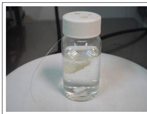
Figura 23 - Sistema utilizado como meio de liberação in vitro para o estudo da liberação controlada de fármaco.
