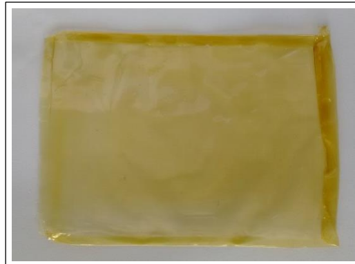
Figura 32 - Membrana de gelatina com ambos os fármacos, reticulada por radiação ultravioleta.
