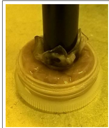
Figura 28 - Prova cilíndrica durante o ensaio de bioadesão.
