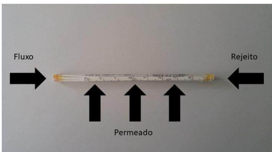
Figura 11 - Módulo da membrana com a corrente de alimentação com concentração do soluto.
