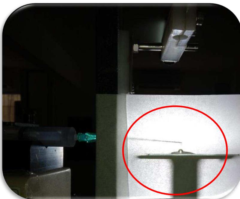
Figura 22 - Imagem representativa da análise na formação da gota no aparelho goniômetro, para as amostras do tubo comercial (Fonte: Própria).
