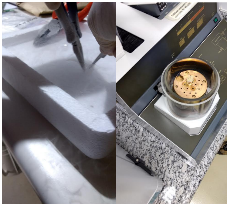
Figura 16 – Fratura dos filmes em nitrogênio líquido e recobrimento com ouro utilizando-se sputter Bal-Tec modelo SCD 005.
