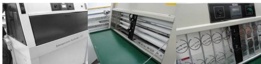
Figura 20 - Detalhes da câmara de envelhecimento acelerado modelo (Bardi,2016).
