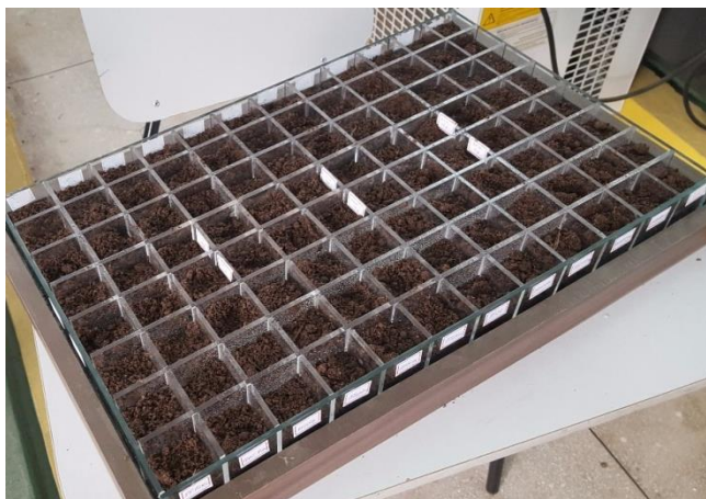
Figura 19 – Caixa de vidro e acrílico utilizada para ensaio de biodegradação.
