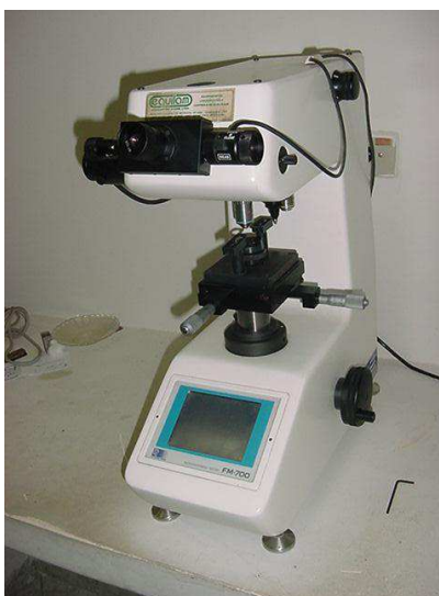
Figura 27 – Microdurômetro digital Future Tech FM-700 (Batista, 2016).
