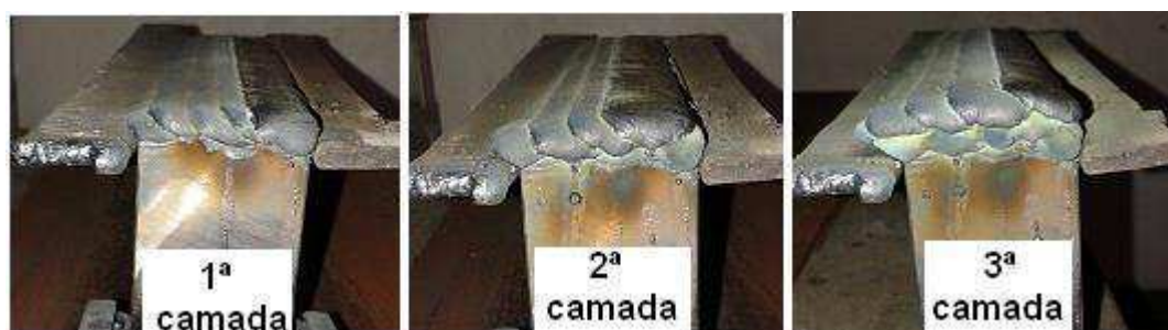
Figura 24 – Sequência da deposição das três camadas de amanteigamento.
