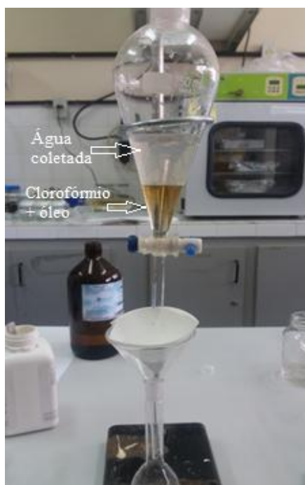
Figura 11 - São verificadas as duas fases no funil: inferior de clorofórmio + óleo e superior com a água da amostra.
