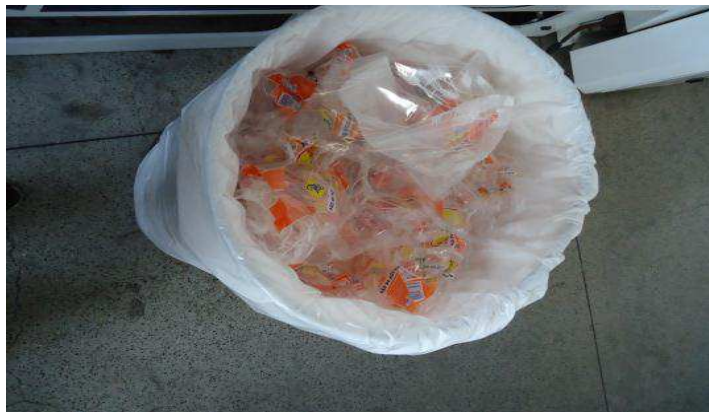
Figura 29. Aparas oriundas do processo de corte e solda (embalagens para pão de forma).
