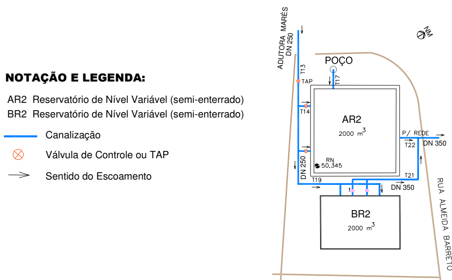
Figura 5.7 – Centro de reservação e distribuição R2.
