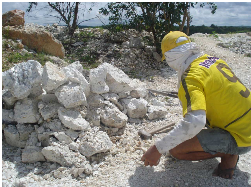
Figura 7: Ausência de equipamentos de proteção.
