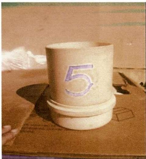
Figura 06 –Coletores Pluviômetros de PVC.
