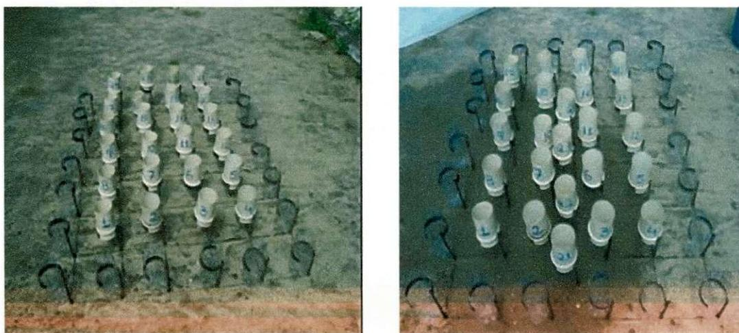
Figura 09– Coletores pluviômetros dispostos em espaçamento de 0,50m (a) e com alguns inseridos a 0,25m (b)
