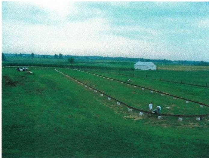
Figura 04. Campo de testes mostrando a declividade suave do terreno e o trilho que delimita o percurso do comboio. Fonte: Tim Stombaugh.
