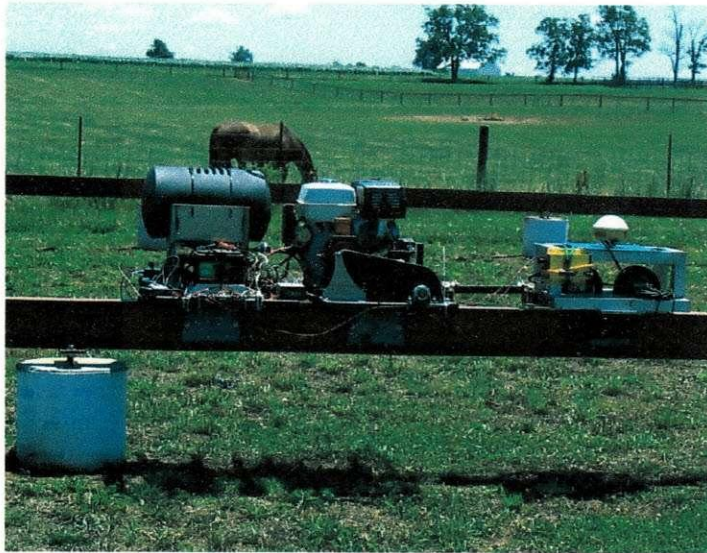
Figura 03. Comboio de testes composto por motor, receptores e trilho delimitando o percurso Fonte: Tim Stombaugh.
