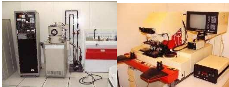
Figura 1 : Depósito de camadas finas (esquerda) e Litografia, gravura e química (direita)
