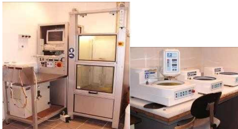
Figura 2 : Fornos para a troca de íons e enterragem (esquerda) e corte e polimento (direita)
