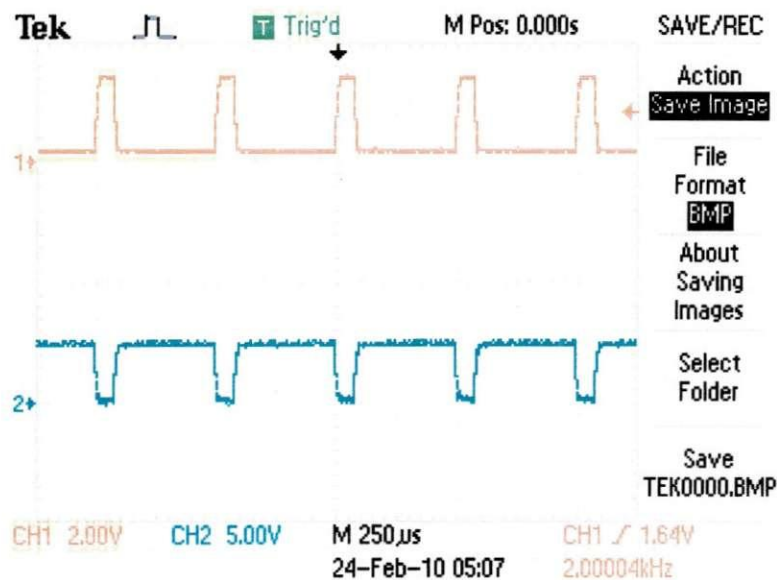
Figure 18: Sinais na saída do circuito OPTO
