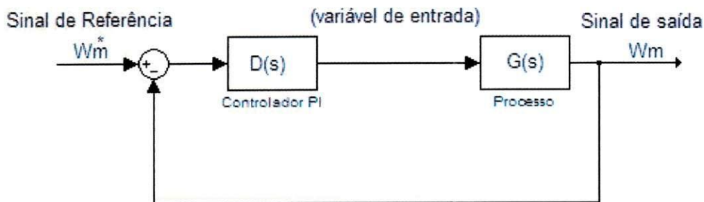
Figure 8: Sistema de controle de malha fechada
