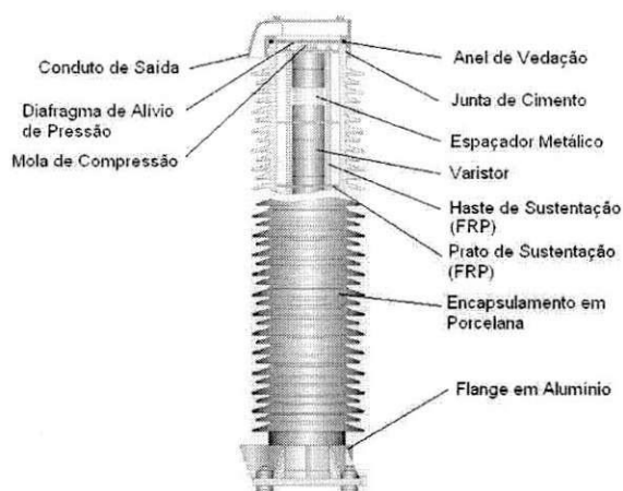
Figura 3. Estrutura de um pára-raios de ZnO com invólucro de porcelana.
