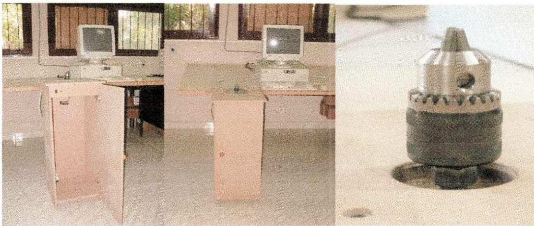
Foto 4: Sistema Posicionador Automático: gabinete de madeira e computador . À esquerda, o gabinete do posicionador com a porta aberta; ao centro, gabinete com a porta fechada; e à direita, detalhe do mandril onde são fixadas as antenas.
