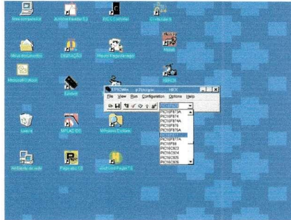
Figura 5.15 - Indicação do tipo de microcontrolador PIC utilizado.
