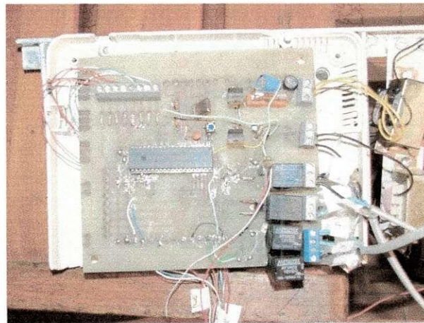
Figura 3.12 - Placa de circuito impresso, face anterior, com os componentes soldados.
