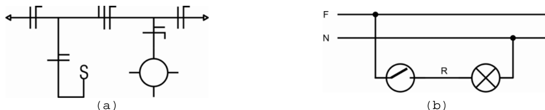
Figura 2. Instalação de uma lâmpada incandescente acionada com um interruptor de uma seção. (a) - Diagrama unifilar. (b) - Diagrama multifilar.
