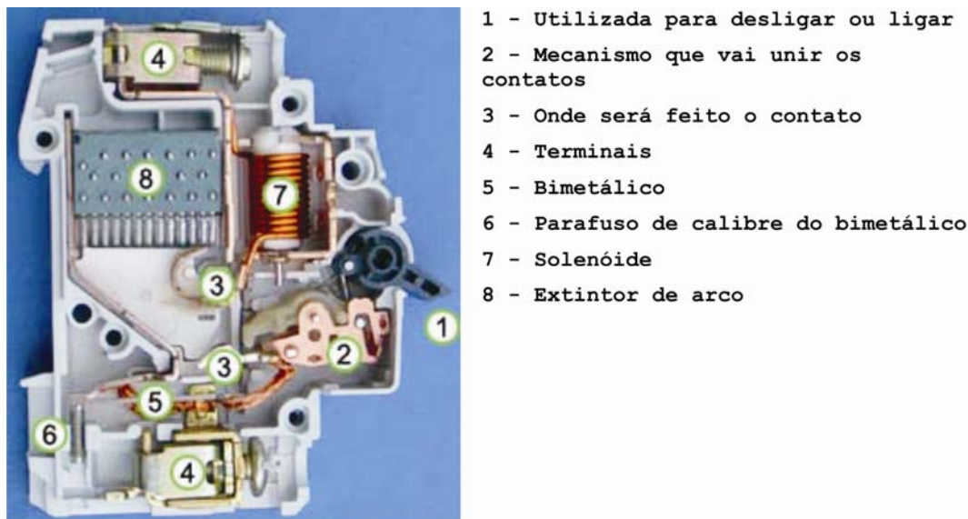
Figura 12. Visão interna de um disjuntor (WIKIPEDIA, 2009c).
