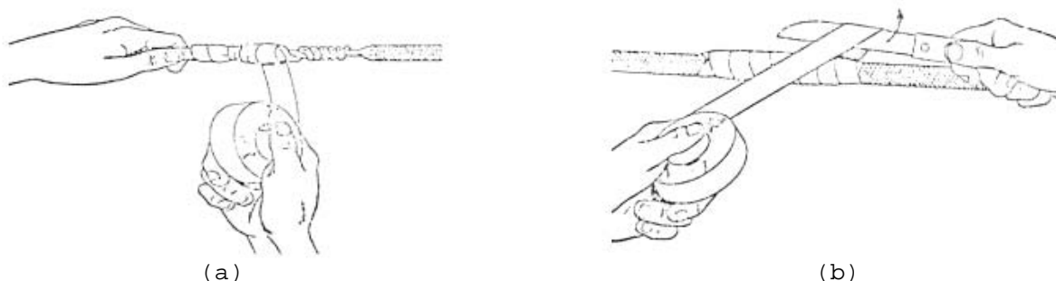
(a) (b) Figura 1, (f) e (g) - Isolando os condutores.
