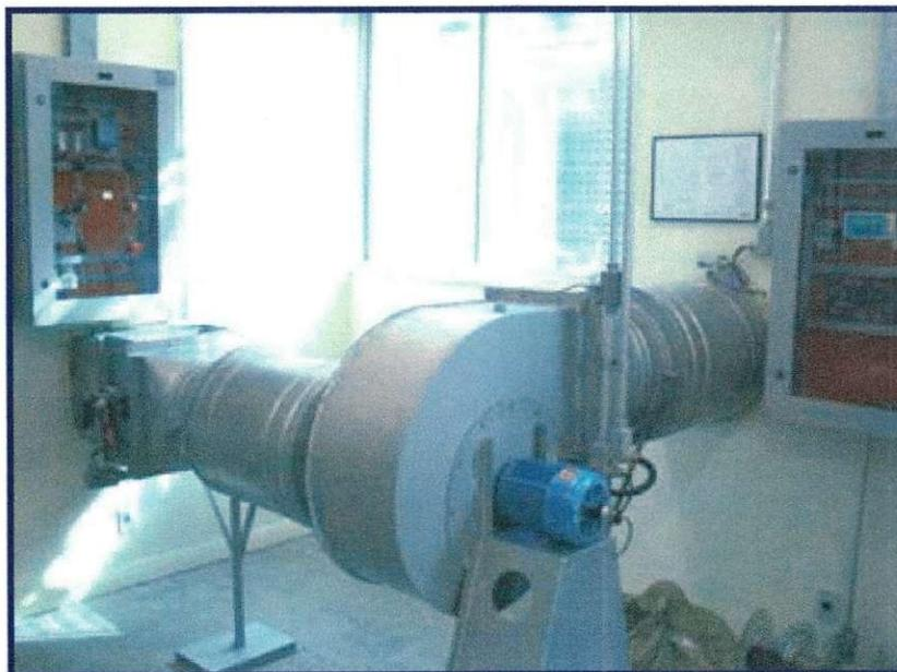
**Figura 3.1 – Ventilador Centrífugo**
