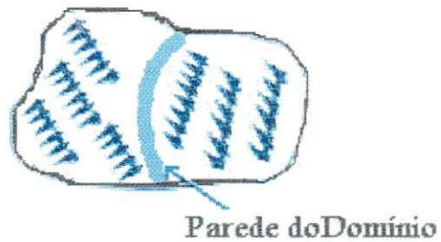
Figura 18: Encurvamento das paredes dos domínios ao se prenderem aos limites do grão.
