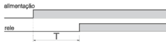
Figura 10: Forma de acionamento do temporizador
