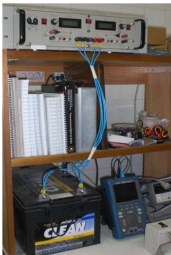
Figura 5.1. Estrutura de ensaios de carga e descarga das baterias – LEIAM.
