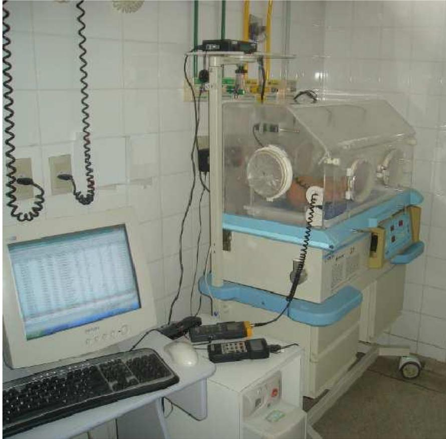
Figura 5.2 – Sistema de aquisição de dados com controle de umidade.
