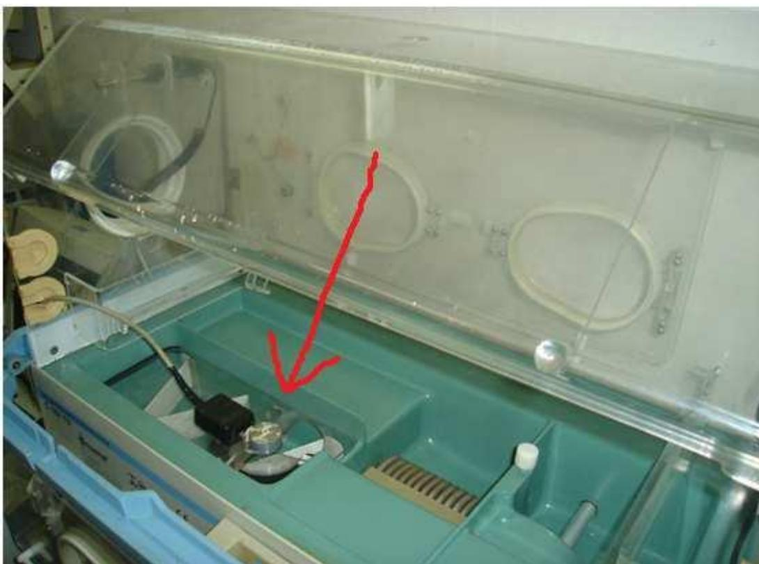
Figura 5.1 – Sistema Controle de Umidade instalado.
