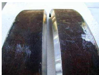
Figura 3. 3 - Dimensionamento e fotos de corpo de prova de X80 preparado para soldagem.
