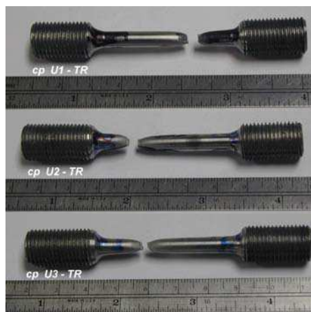
Figura 4.26 - CPs de tração fraturados – U70
