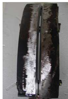
Figura 3. 3 - Dimensionamento e fotos de corpo de prova de X80 preparado para soldagem.
