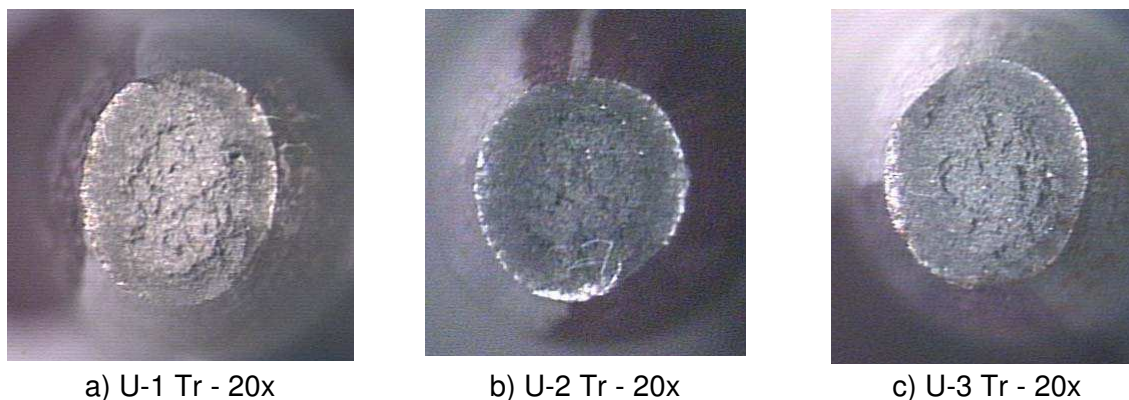
Figura 4.27 - Fotos das superfícies de fratura dos cps de tração – U70
