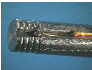
Figura 3.12 – Pino de implante com termopar
