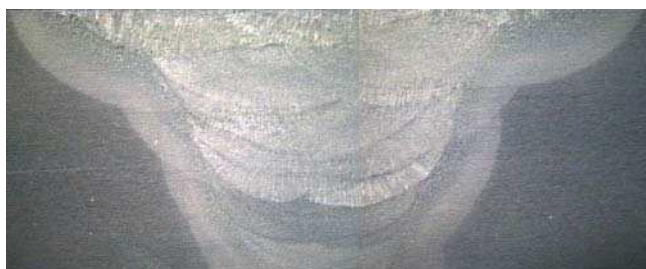
Figura 4.23 - Montagem de macrografias da junta soldada do aço perlítico - 15x de aumento
