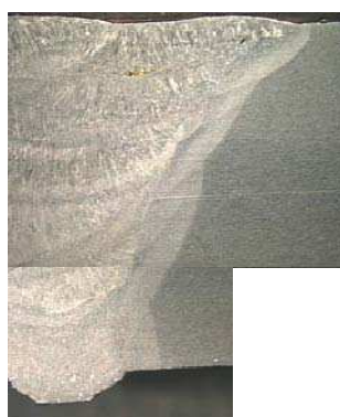
Figura 4.1 – Montagem de macrografias da junta soldada do aço bainítico - 10x de aumento
