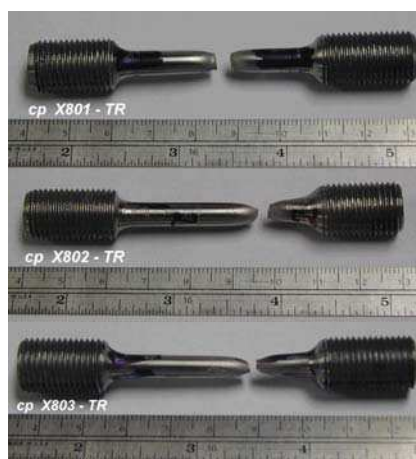
Figura 4.5 - CPs de tração fraturados - X80
