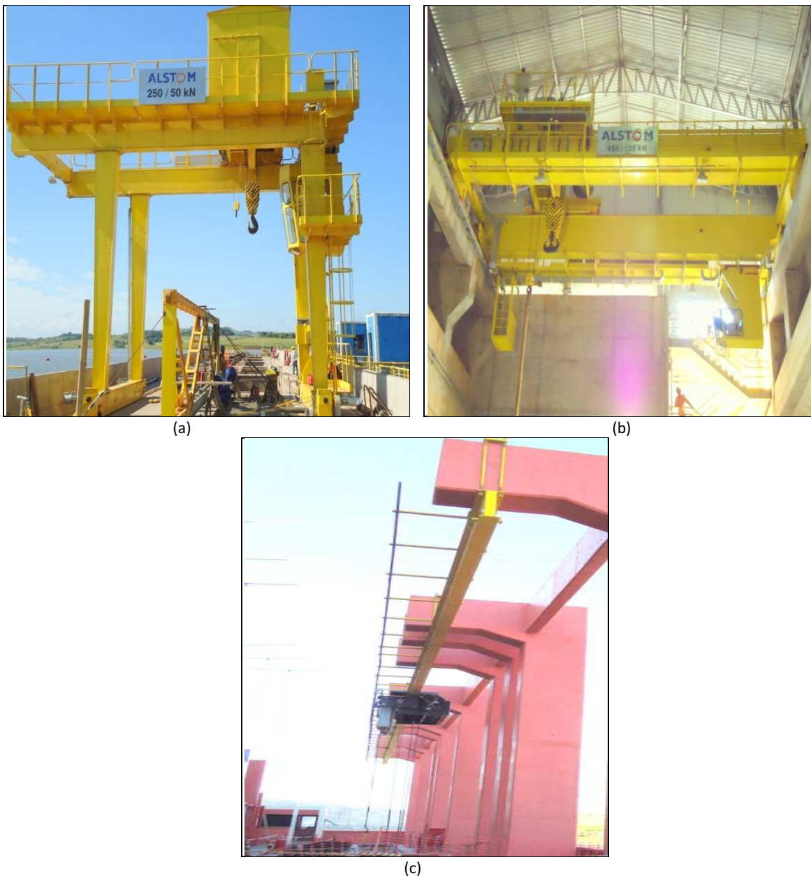
Figura 8. (a) Pórtico Rolante, (b) Ponte Rolante e (c) Talha Monovia em atividade na UHE São José (2011).
