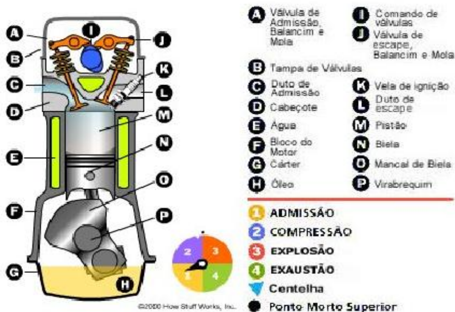
Figura 06: Constituição de um motor de quatro tempos
