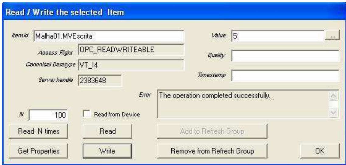
Figura 28: Interface de configuração de escrita para o cliente OPC
