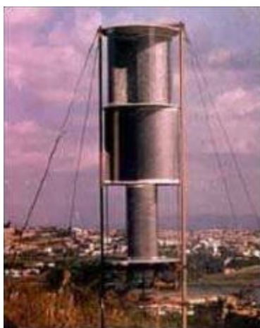
Figura 2.21 - Turbina Savonius. Fonte: Colégio São Francisco.
