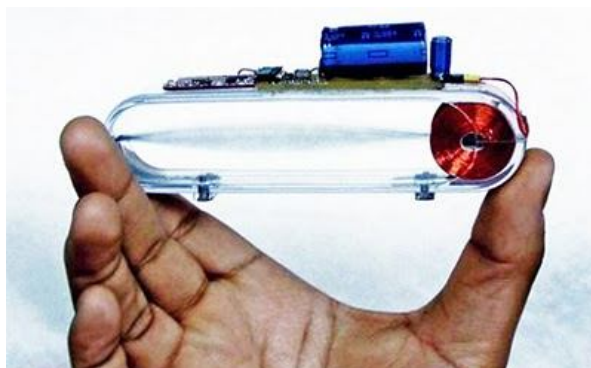
Figura 4.9 - Micro gerador eólico (Windbelt). Fonte: a-casa-ecologica.blogspot.com
