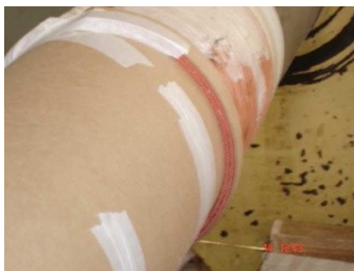
Figura - Fotografia ilustrando a colocação da cabeceira na extremidade da bobina.
