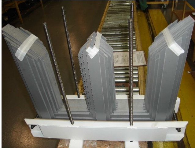
Figura - Fotografia ilustrando núcleo do transformador com parte de cima aberta.
