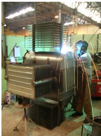
Figura - Fotografia ilustrando o processo de solda dos radiadores no tanque do transformador.
