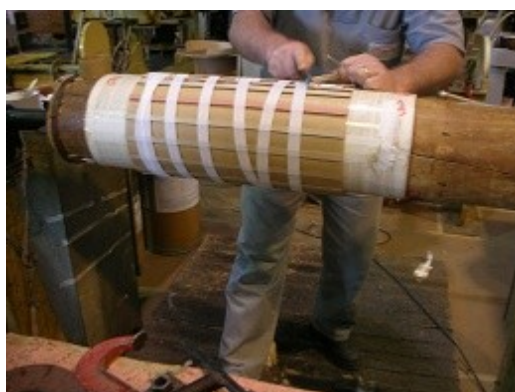
Figura - Fotografia ilustrando a colocação do canal de óleo (regreta) na bobina.
