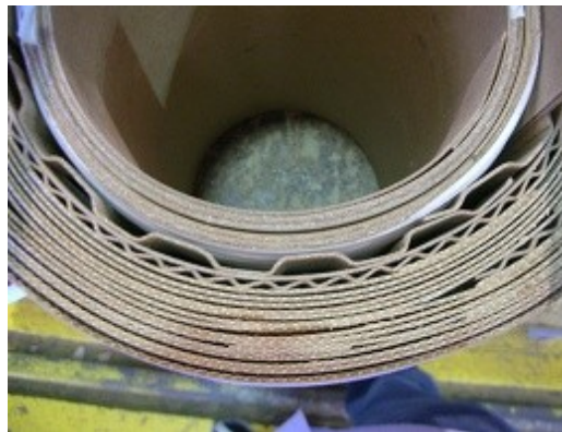
Figura - Fotografia da vista superior das bobinas de alta tensão e baixa tensão.
