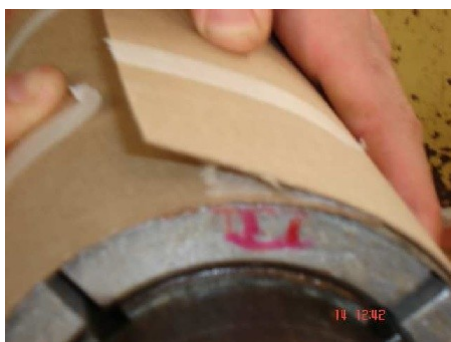
Figura - Fotografia ilustrando a colocação do tubo de baixa tensão na bobinadeira.
