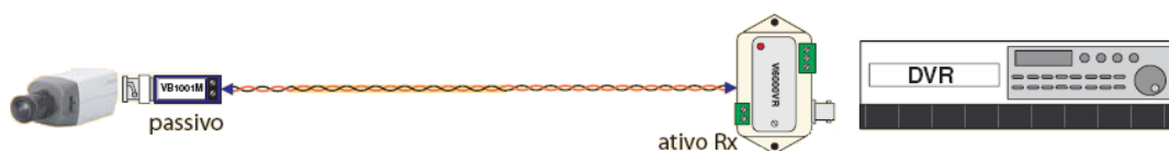
Figura 4.4: Exemplo de utilização do conversor de vídeo passivo com ativo.
