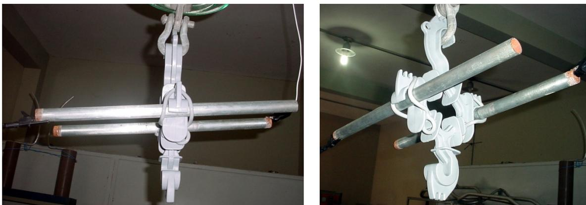
Figura 13. Arranjo para aferição da corrente de fuga dos espaçadores Prysman, 15 kV.
