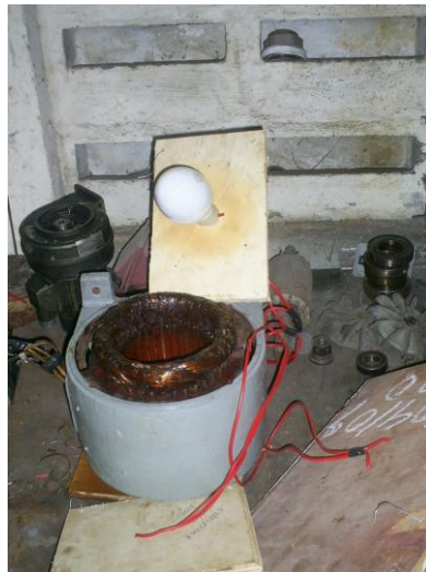
Figura 5: Esquema improvisado com lâmpada mista de 160 W funcionando como estufa
