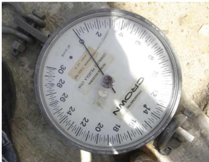
**Figura 8 – Fotografia do dinamômetro utilizado.**
