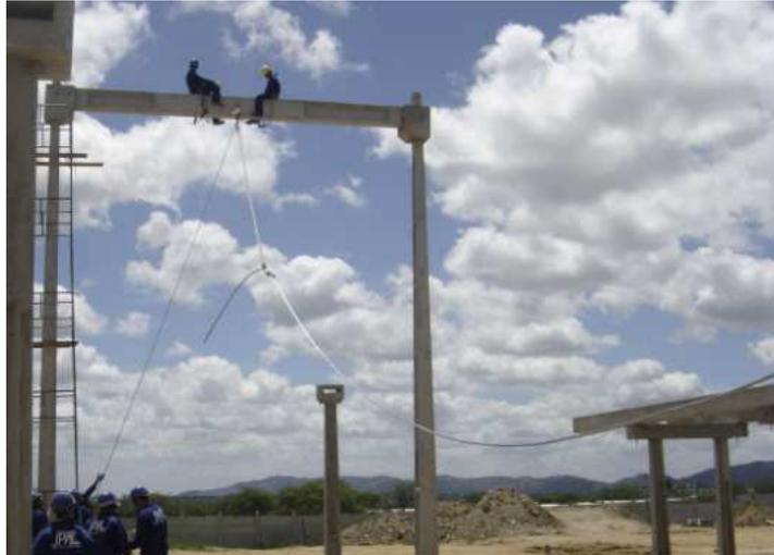
**Figura 9 – Fotografia da medição intensidade de força exercida pelo cabo.**
