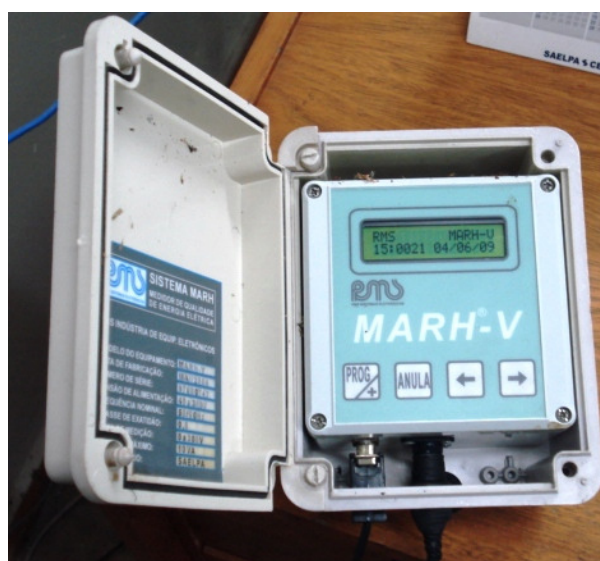
Figura 6 – MARH – V, medidor de tensão
