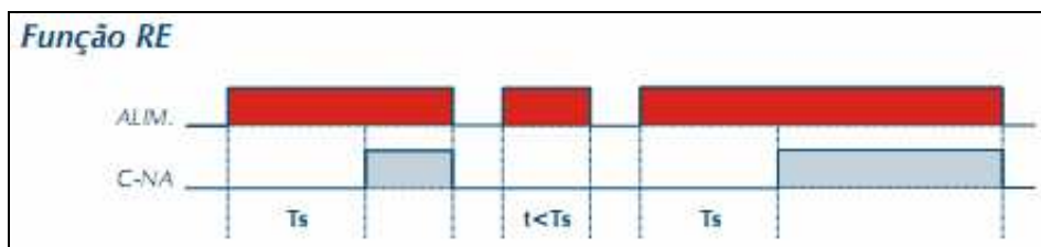
Figura 15 - Diagrama Ilustrativo da Função Retardo na Energização dos Relés de Tempo
