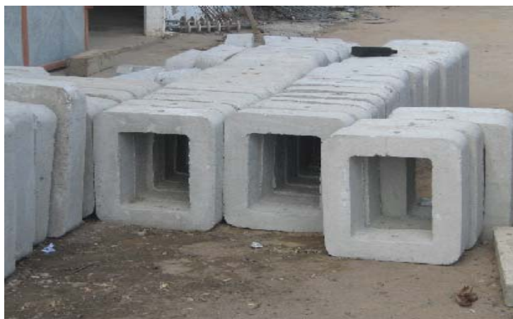
Figura 18 - Anéis de Concreto
