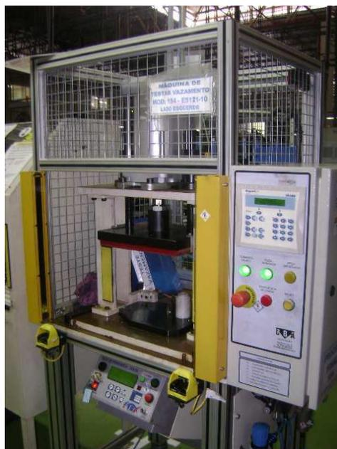
Figura 11b: Teste de estanqueidade com a cortina de luz
