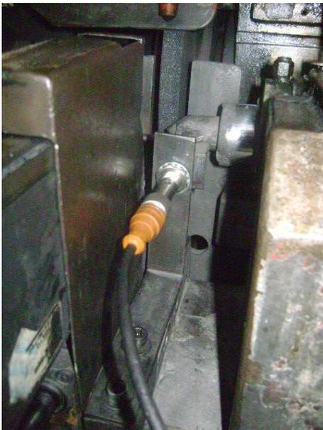
Figura 10a:Foto do sensor indutivo no suporte
