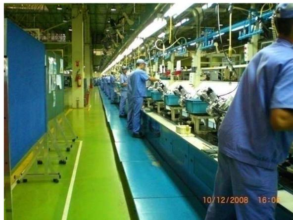
Figura 8 – Linha de Montagem B do motor.
