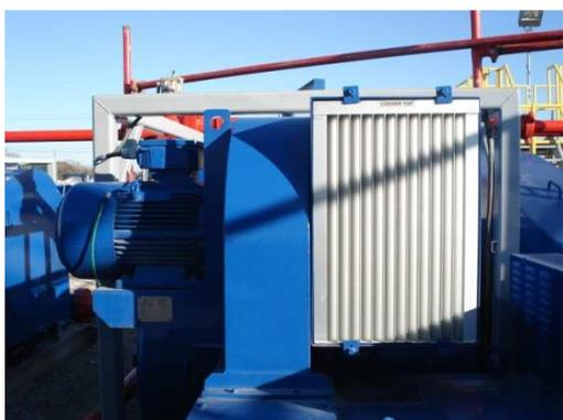
Figura 18 - Sistema de ventilação dos motores das Bombas de Lama e Drawworks
