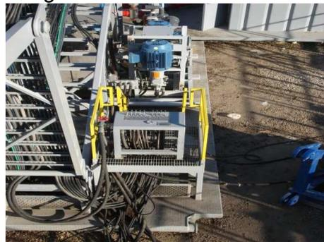
*Figura 10 - Unidade de Energia Hidráulica*
