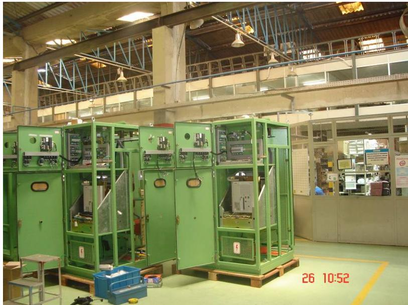
**Fig. 17 – Montagem Eletromecânica dos Painéis**
