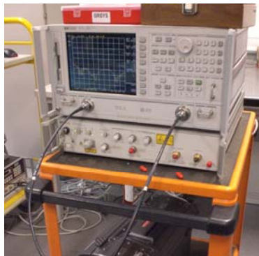
Figura 4.3. Analisador de redes «HP-HEWLETT PACKARD 8720D Network Analyzer 50 MHz – 20 GHz ».
