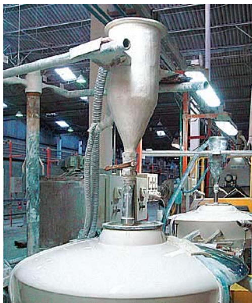
Figura 3.8 - Aplicação da camada de esmalte
