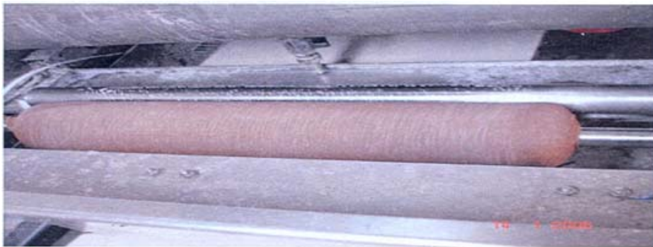
Figura 6.12 - Rolo com impermeabilizante
