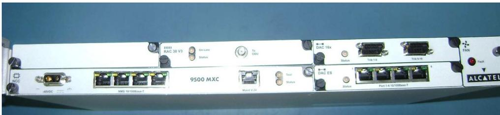
**Figura 9** : IDU do rádio de microwondas 9500 MXC- Alcatel-Lucent
