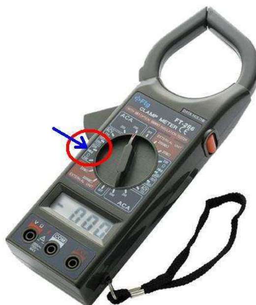
Figura 4.1 – Multimetro na opção de teste sonoro para verificação de continuidade
