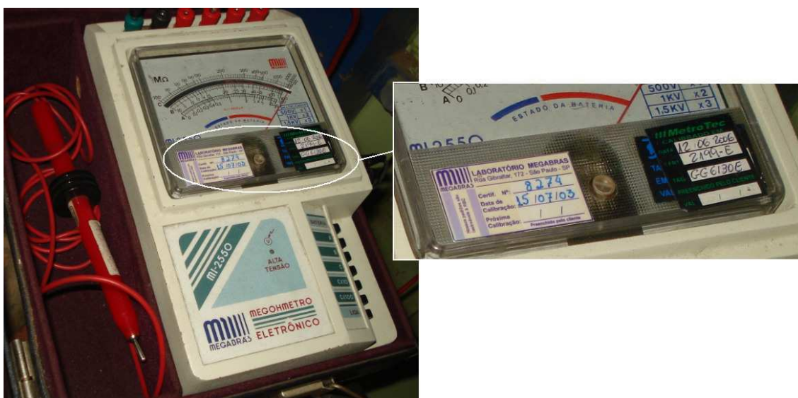
Figura 4.6 – Megometro com calibração vencida
