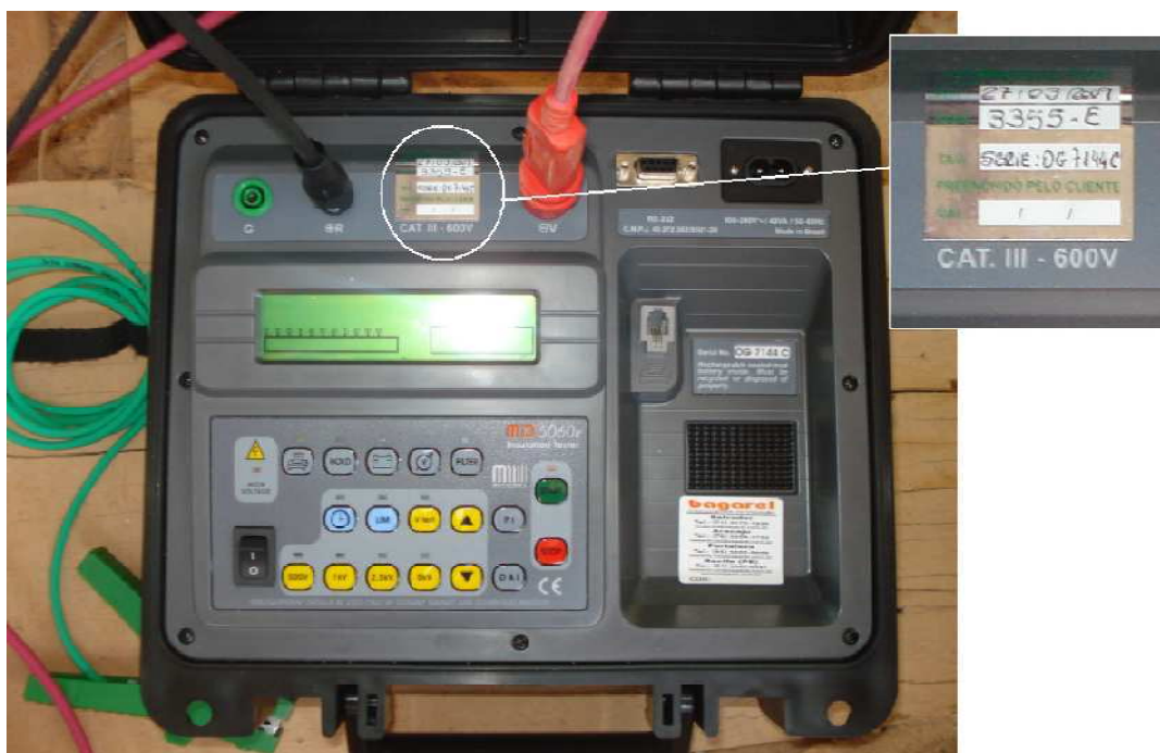
Figura 4.7 – Megometro com calibração normalizada
