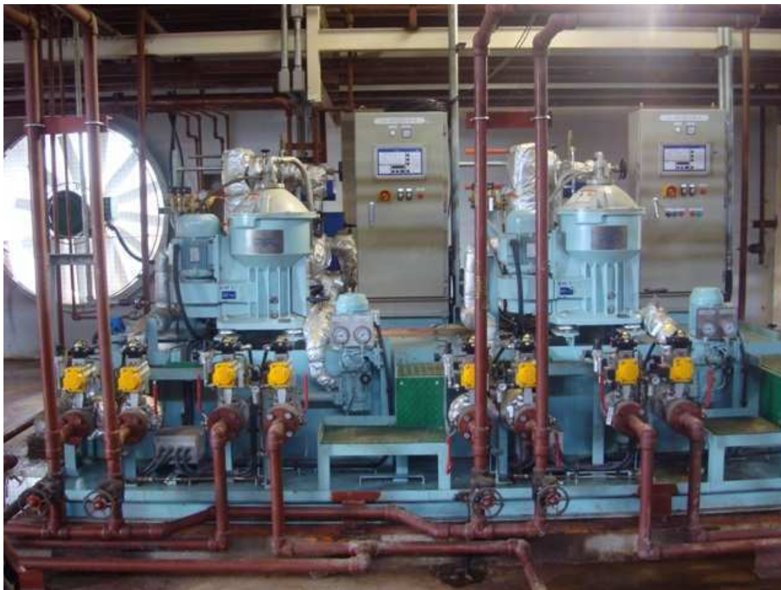
Figura 3.4 – Sistema do Módulo Separador
