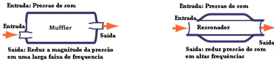
Figura 35 – Esquema do sistema de escape com Muffler e com ressonador
