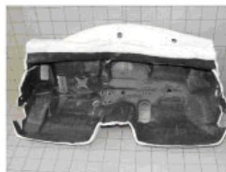
Figura 38 – Foto do painel de isolamento de som do veículo
