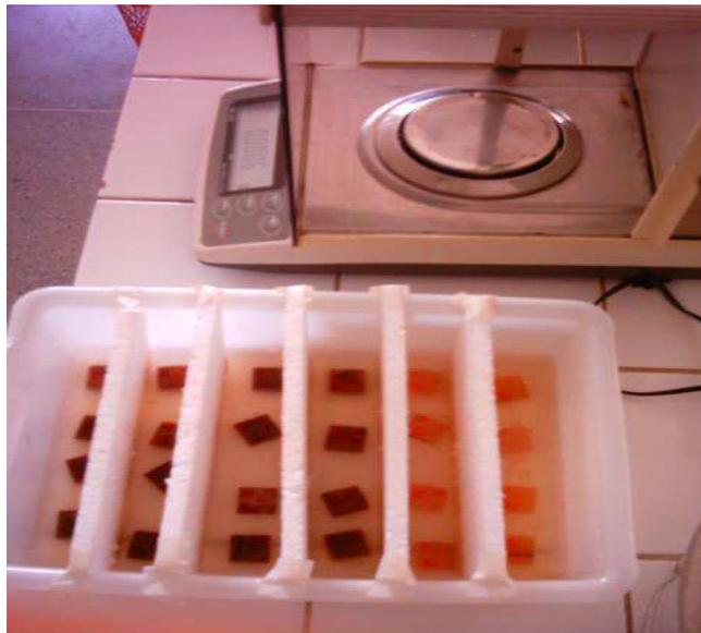
Figura 4.5– Equipamentos utilizados para o ensaio de sorção de água. Fonte:(Alexandre, 2005).
