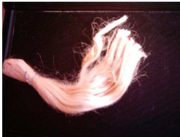
Figura 4.1 – Fibras da folha do abacaxi desfibradas e penteadas. Fonte: Alexandre (2005).
