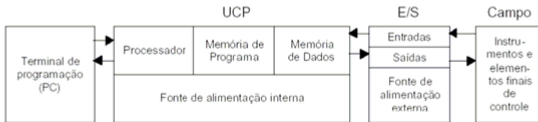
Figura 4.1.1 - Diagrama de blocos de um CLP
