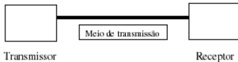
Figura 4.4.1 – Elementos de uma comunicação básica.
