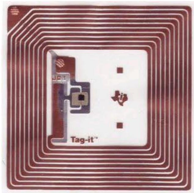
Figura 4: Estrutura de uma tag/Fonte: [www.sagedata.com](http://www.sagedata.com)
